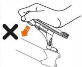
Zarovnejte horní prohlubně v pouzdře s horním výstupkem na držáku, vložte pouzdro na místo a pevně jej zatlačte směrem k sedlu (1). Současně pouzdro zlehka tlačte směrem dolů, aby zaváčilo na místo (2). Poznámka: Budete-li chtít pouzdro použít v režimu na šířku, otočte je a postupujte stejně.
