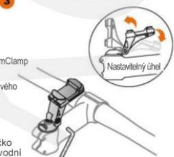
Vyšroubujte šroub z horního víčka hlavového složení, ale víčko ponechejte na místě. Držák StemClamp umístěte na toto původní víčko tak, aby směřoval dopředu, a zajistěte jej pomocí dodaného delšího šroubu. Pevně utáhněte pomocí 4mm inbusového klíče, ale nepoužívejte přílišnou sílu.\* POZNAMKA: integrované víčko, které je součástí držáku StemClamp, NENAHRAZUJE víčko vašeho hlavového složení, ale montuje se na to původní.
